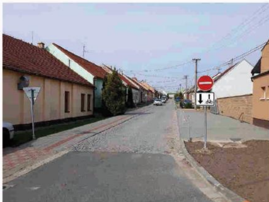
Foto č. 2 – pohled na výjezd z ul. Střední do ul. Za Dvorem a umístění nové DZ E12b na stávající DZ B2
