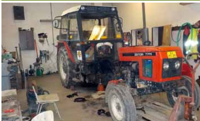
Výměna spojky na městském traktoru – opravu provedli pracovníci služeb města
